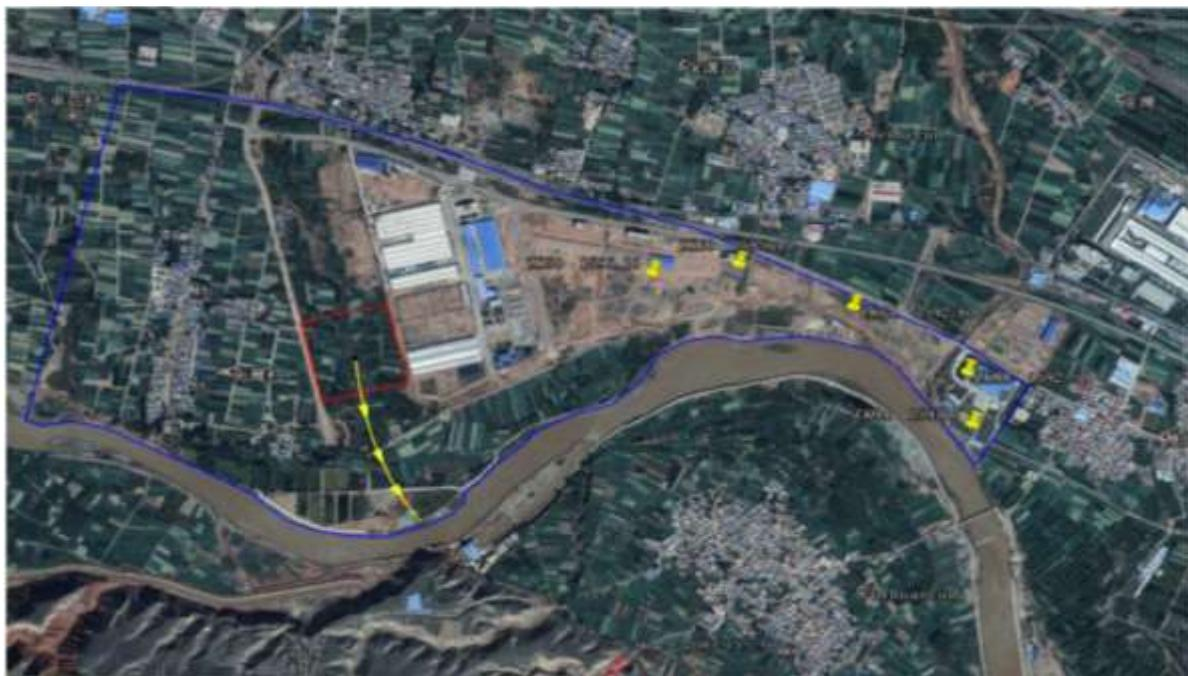
图 4.2-20 从厂区内出发的示踪粒子迁移迹线图（迹线中每一格代表 365d 迁移距离）
